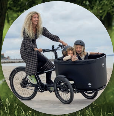
Das MK1- E von Butchers & Bicycles ist ein Dreirad, das sich dank einer innovativen Neigetechnik und Achsellenkung wie ein Zweirad fährt.
